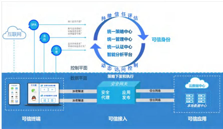
UniSDP系统由管理服务端和可信客户端组成，管理服务端集成了UniSDP Controller控制器模块、APN安全网关模块，控制平面与数据平面分离。
