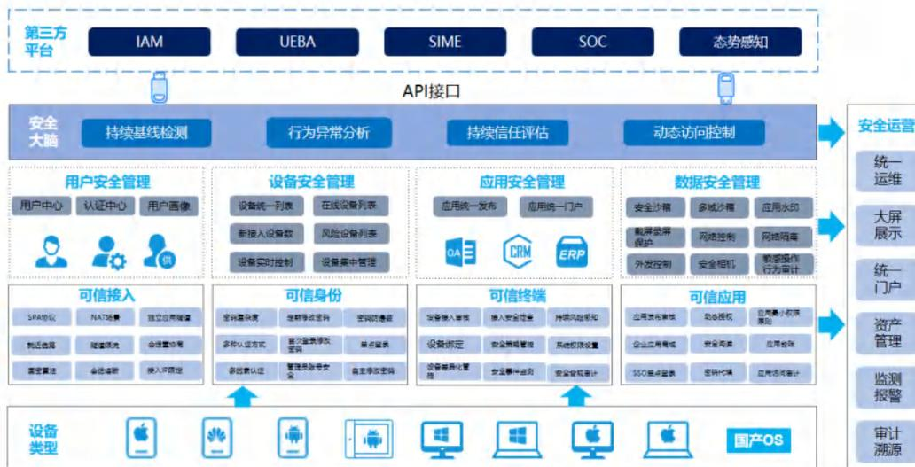
UniSDP零信任访问控制系统基于零信任的架构，围绕着身份、接入、设备、应用和数据这5个方面来进行构建，通过可信的身份，使用可信的终端，以可信的接入方式，访问可信的应用，数据安全落地。
